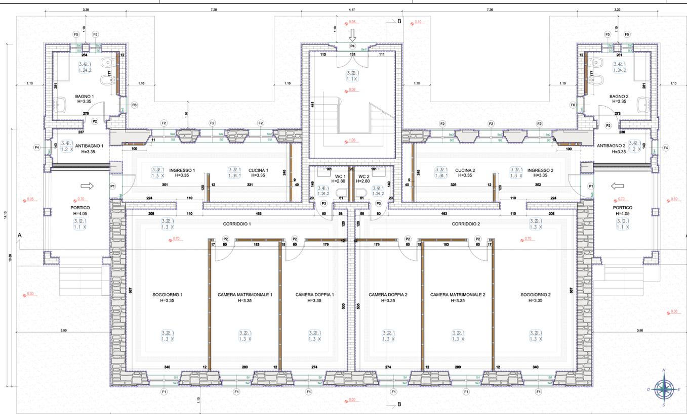
PIANTA PIANO TERRA STATO DI PROGETTO - FINITURE - Sc.1:50
